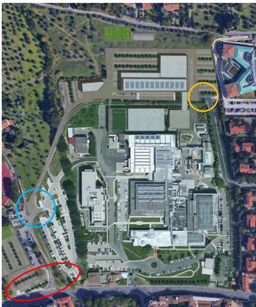
Figura 3 – schema accessi e viabilità di progetto In giallo l'accesso esistente su via Ragionieri; in rosso la nuova intersezione a raso fra via Gaddi e via Ragionieri e le modifiche agli accessi del parcheggio esistente; in azzurro la nuova viabilità privata di collegamento fra via Gaddi e l'ambito AT57a
